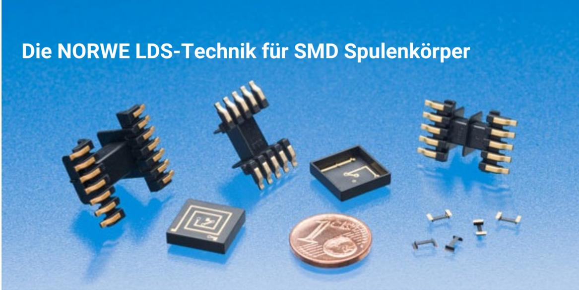
NORWE hat das LDS-Verfahren mit der Möglichkeit von vernetzten Kunststoffen weiterentwickelt, um Kontaktierungen von Wickeldrähten ohne Lötstifte direkt am Kunststoff zu ermöglichen. Die Vorteile sind überzeugend – Bauteilreduzierung, vereinfachte Anschlussstechnik, geringeres Bauteilegewicht, optimale Koplanarität, Durchkontaktierung sowie die Realisierung von kleinen bzw. mittleren Serien ohne zusätzlichen Aufwand für eine Bestückungstechnik.
